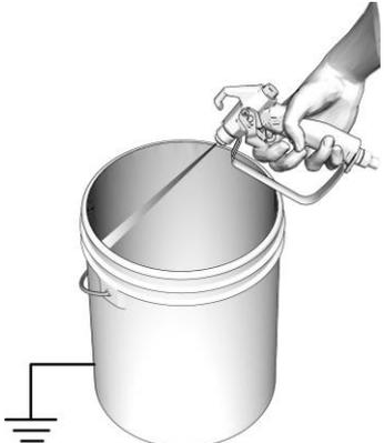
Закройте Кран сброса давления ЛКМ из фильтра 12 (см. стр. 8). На распылительном пистолете снимите блокировку курка (см. стр. 11). Плотнo прижмите металлическую часть пистолета к заземленному металлическому ведру. Нажмите на курок пистолета. Увеличивайте давление воздуха с помощью Регулятора давления 7 (см. стр. 8) до запуска насоса. Используйте минимально возможное давление. Осуществляйте промывку до полной очистки.
