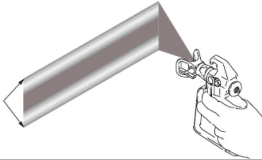
Выполните пробное распыление. Отрегулируйте давление насоса с помощью Регулятора давления 7 (см. стр. 8), чтобы устранить излишки краски на кромках. Используйте сопло меньшего размера, если с помощью регулировки давления не удастся устранить излишки краски на кромках.
