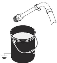
Откройте Кран сброса давления ЛКМ из фильтра 12 (см. стр. 8), поместите сливной патрубок в контейнер для отходов. Поместите всасывающий шланг в заземленное металлическое ведро, частично заполненное промывочной жидкостью. См. раздел Заземление (см. стр. 2).
